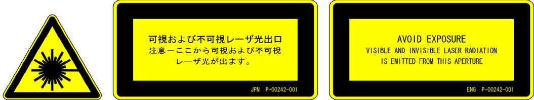
高出力のレーザーを伝送させる出射ユニットには 3 種のレーザー警告ラベルが添付されています。製品本体もしくは製品の近くに貼ってご使用ください。
