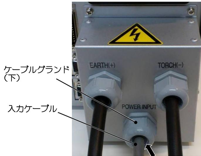
3. 入力ケーブルの 2 本の電源線（黒）・（白）の丸端子を電源入力端子（L1）（L2）にそれぞれ接続します。
