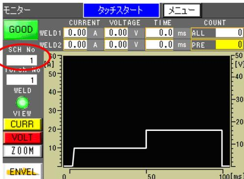
2. モニター画面の「SCH No」の項目に溶接条件が設定されている条件番号が表示されているのを確認します。SCH の選択を外部 I0 で選択する場合にはこの表示は通電終了後に更新されます。
