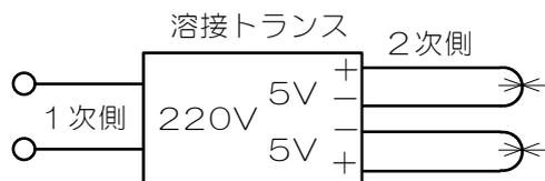
$$\text{巻数比} = \frac{1 \text{ 次入力電圧}}{2 \text{ 次出力電圧}} \times \frac{1}{2 \text{ 次回路数}}$$
