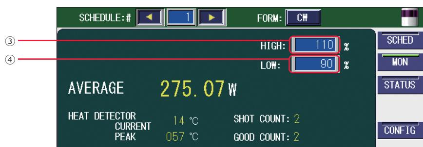
⇒ CW モードでスロープの判定をしない場合、CONFIG 画面で LASER CONTROL を選択し、「CW SLOPE CHK DISABLE」を ON に設定します。
