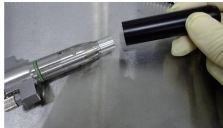
(2) 光ファイバー先端の保護キャップを取り外します。
