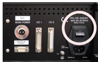
4. 照明コントローラーの「POWER」スイッチを“○(OFF)”にして、スイッチ内蔵のランプを消灯させます。
