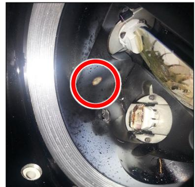
水分・油分汚染による光学部品損傷
