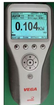
パワーメーターを使い、下記の手順でスキャナーヘッド下のレーザー出力を測定してください。
