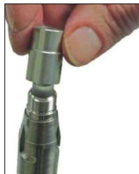
3. 光ファイバーケーブルの先端をQBHホルダーに差し込みます。
