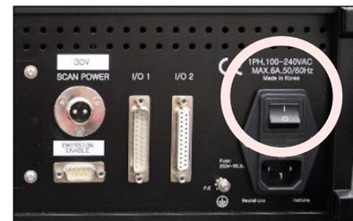
(2) スキャナーコントローラー前面にある「POWER」スイッチを“1”にして、スイッチ右横のランプを点灯させます。
