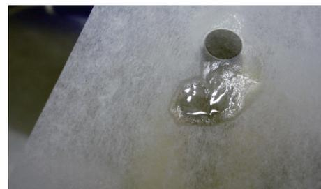
(5) 石英ブロック先端に汚れ、ほこり、拭き残し跡がないことを確認し、保護キャップを再度取り付けます。
