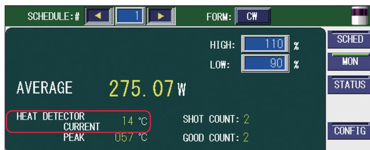
表示温度が低い場合には、出射ユニットの保護ガラスが汚れていないか確認してください。また、塵埃、ガス、湿気が多い環境でも温度表示値が低下しますので、注意してください。逆に、高く表示される場合には、近くに高温の熱源や照明などがいないか確認してください。特に問題がない場合には、補正率を調整して使用してください。
