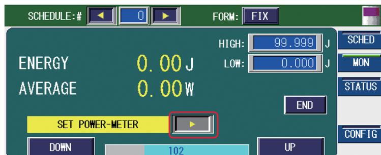
(3) 出力を増加させるときは「UP」ボタンを、低下させるときは「DOWN」ボタンを押します。
