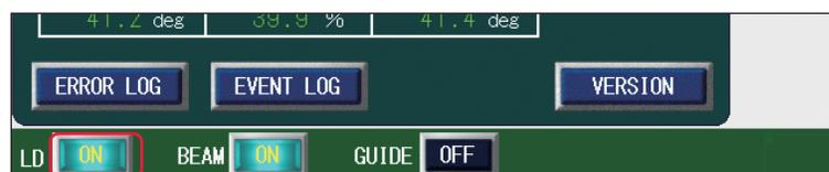
(4) 時間分岐の場合は、「BEAM」設定ボタンを押します。
