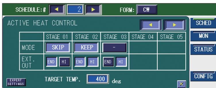
(2) 「STAGE 01」～「STAGE 20」の「MODE」設定ボタンを押して、波形の各ステージに制御方法を設定します。
