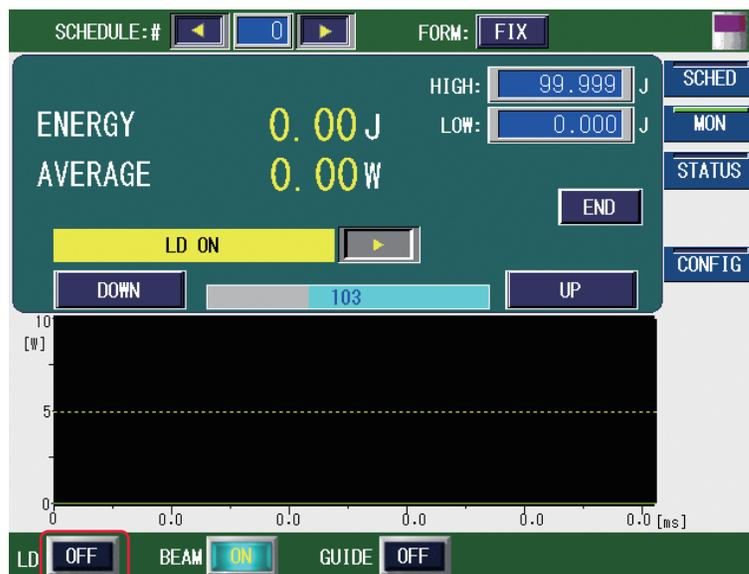
(5) レーザコントローラの LASER START/STOP ボタンを押します。
