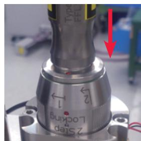
(3) 出射ユニットコネクタ部に記載の 1 の矢印の方向に、出射ユニットコネクタ部を 37° 程度回します。
