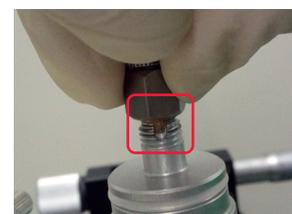
(2) プラグ外側のキャップナットを矢印の方向へ回して固定します。
