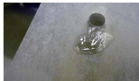
(5) 石英ブロック先端に汚れ、ほこり、拭き残し跡がないことを確認し、保護管を再度取り付けます。
