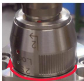
(4) 出射ユニットコネクタ部を 2mm 程度光ファイバ側に引き、2 の矢印の方向に回します。
