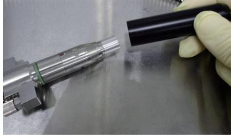
(2) 光ファイバ先端の保護管を取り外します。
