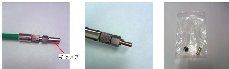
(3) 端面チェッカー側の溝と光ファイバ側のツメを合わせて、端面チェッカーに光ファイバを取り付け、斜め方向から照明光を当てます。
