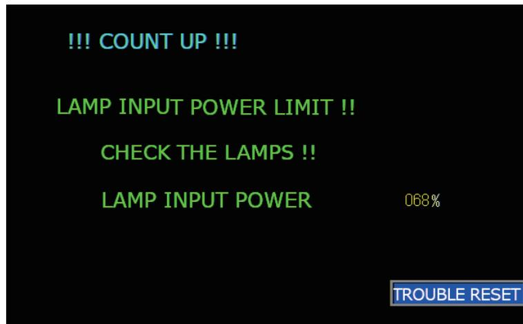
この画面が表示されると、外部出力信号 EXT.I/O(1) コネクタの出力用 9 番ピン（ランプ投入上限）が、開路出力します。
