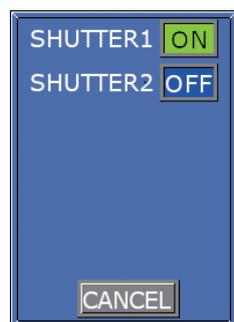
(2) 接続した光ファイバに対応した「SHUTTER 1」～「SHUTTER 2」設定ボタンを押し、ON を設定します。
