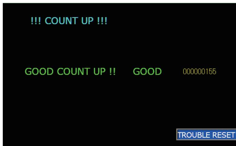
「SHG COUNT」が設定した値に達すると、波長交換結晶の点検を促す画面が表示されます。
